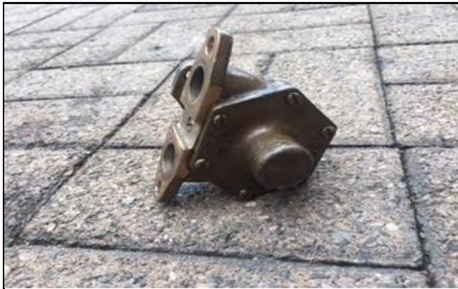
**Impellerpumpe Volvo Penta
